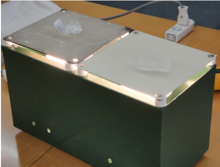
写真左の鉄板はガイナ、右の鉄板は一般塗料を塗布したもの。氷を乗せて実験
